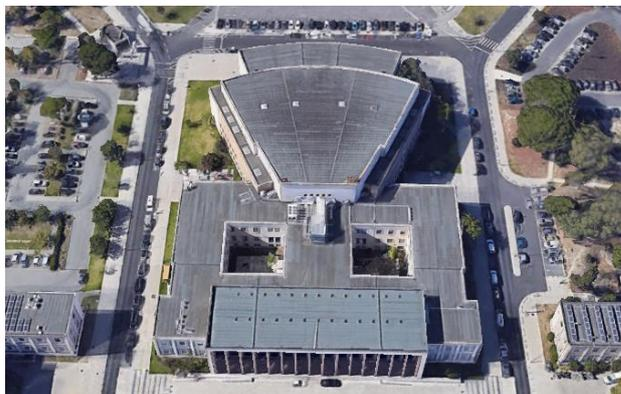
A *figura 18* evidencia a superfície do telhado da edificado da Reitoria e da Aula Magna que tem um total de 9750 m<sup>2</sup>. Não tem painéis fotovoltaicos. A taxa de ocupação é de 0%. Estima-se que poderá ter 1022 painéis fotovoltaicos.
